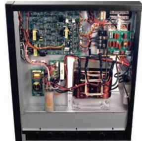
Изолирующий трансформатор, аккумуляторные батареи снизу в лотке
