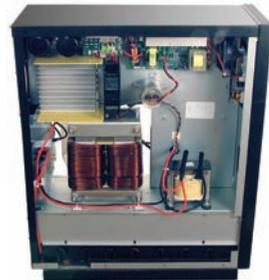
Изолирующий трансформатор, аккумуляторные батареи снизу в лотке
