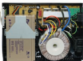
Высокоэффективный тороидальный трансформатор
