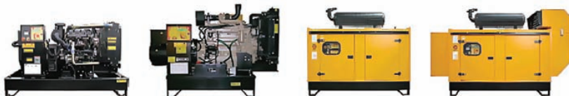
ДГУ ДЭС серии MegaFull с двигателями Perkins, John Deere (30 ... 650 кВА) Открытые (В, М) или в защитных кожухах (всепогодных С, шумозащитных S, супершумозащитных SS) с топливными баками стандартной, увеличенной или повышенной емкости
