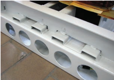
Дополнительные ребра жесткости существенно укрепляют конструкцию
