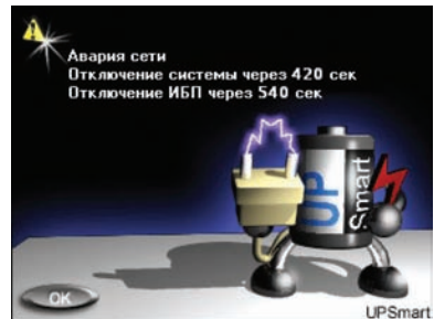
Предупредительное сообщение при аварии электросети
