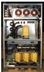
Задняя компоновка: изолир. трансформатор
