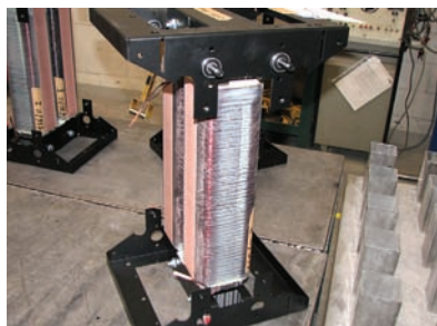
Сверхмощные вариаторы (сборка из двух параллельных единиц)
